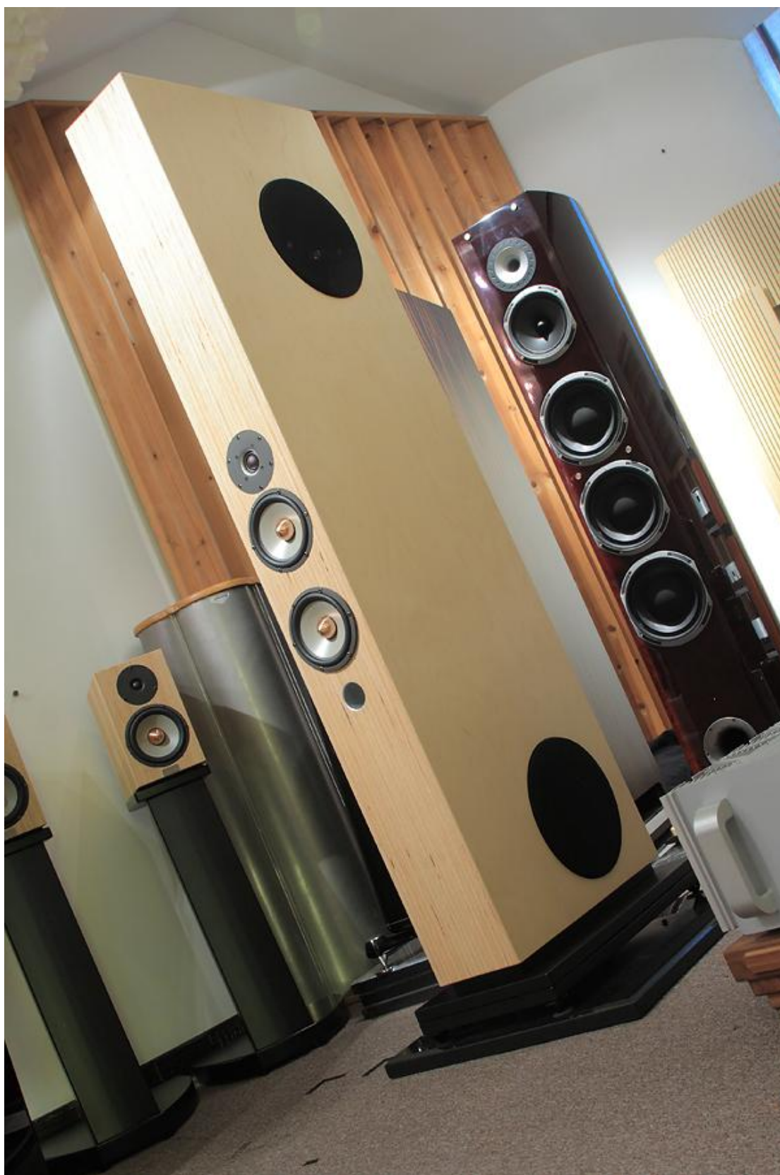
Sinfonia 用了兩顆 10 吋低音單體，低頻延伸可達 20 Hz，規格極為優異。
